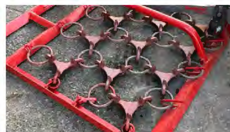
Sterne mit Stegen und Spitzen, beidseitig einsetzbar
