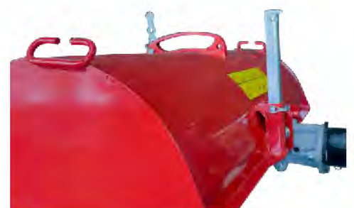
Deck, Stutzen und Abbaustütze
