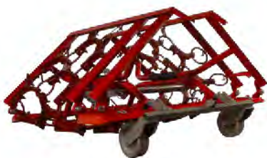
Transport und Handling Durch den Klappmechanismus ist eine schmale Gesamtbreite und damit ein interessantes Transportmass erreichbar. Bei Verwendung des optionalen Fahrwerks vereinfacht sich das Handling enorm.
