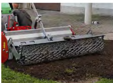
In einem Arbeitsgang Altrasen einfräsen
