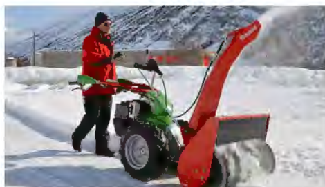
Anpassung des Schneewurfziels während der Fahrt bequem vom Holm aus
