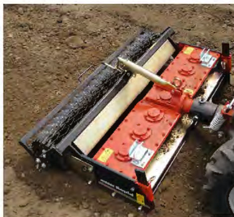
Stufenlose Einstellung der Arbeitstiefe mittels Handspindel
