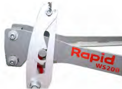
In Transport- oder Verladestellung, Wiesenschlepe fixiert
