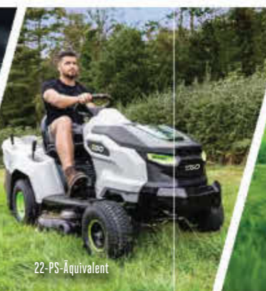
3-in-1-Funktionen – Seitenauswurf, Mulchen oder Sammeln (Fangkorb separat erhältlich)
